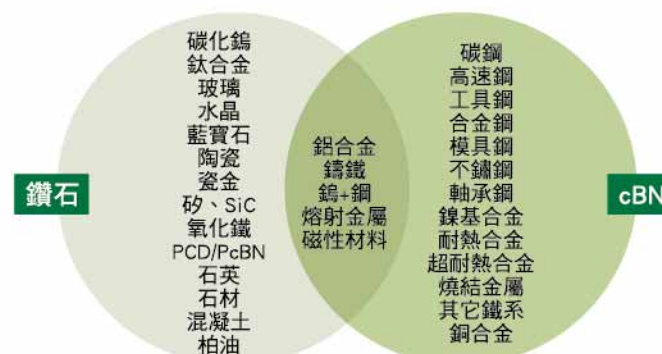
圖2. 鑽石及cBN磨料適合磨削的工件
