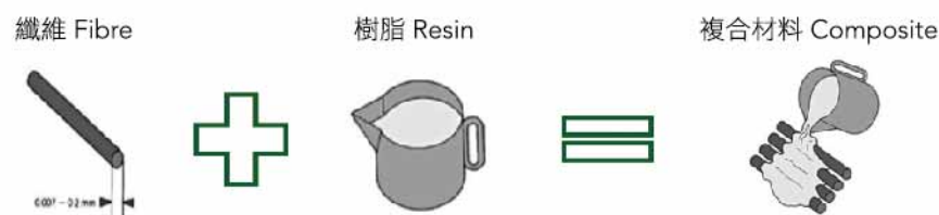
兩種不同成分所組成的材料 Material made of two components
