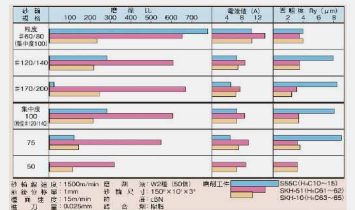
圖5. 磨料粒度/集中度vs磨削比/磨削性/面粗度
