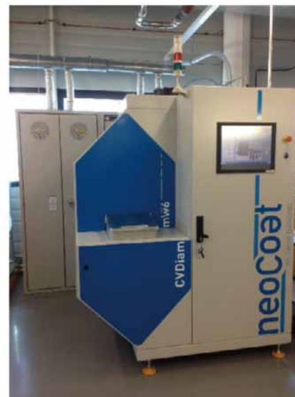
瑞士單晶培育鑽石微波 CVD 長晶設備
