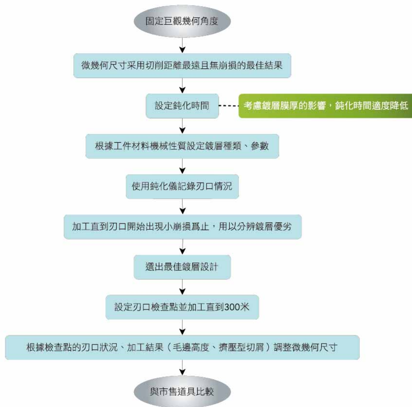
圖3刀具鍍層測試流程圖
