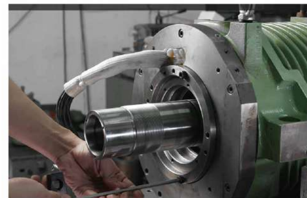
Fig. 3 主軸拆卸過程
