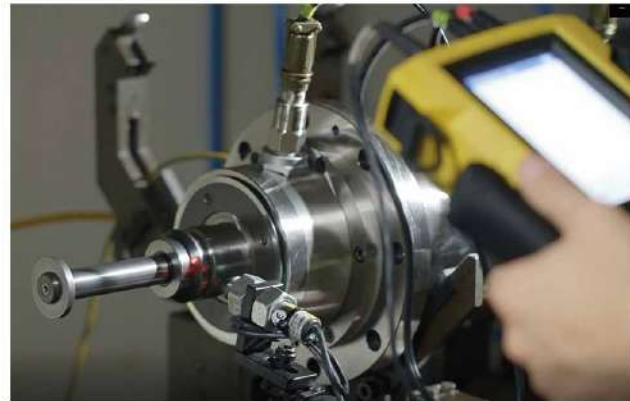
Fig. 7 主軸跑合測試
