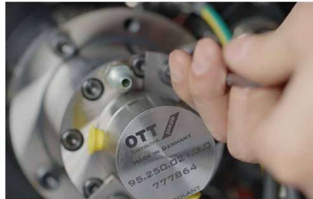
Fig. 6 主軸組裝過程
