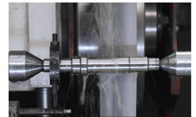
Fig. 4 心軸研磨修整
