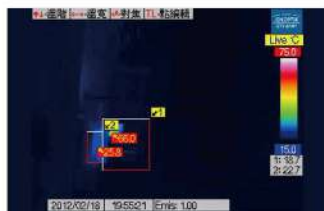
(圖五) PCD切削鋁合金加工溫度為54.6度
