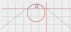
圖11. 焦點變化設備與原子力顯微鏡之間切削刀口半徑測量的比較。 刀口輪廓圖中的每個網格代表2μm。 藍色：測量的表面輪廓。紅色：半徑的擬合圓。
