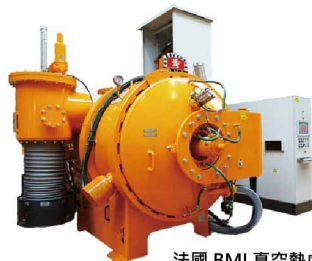
法國 BMI 真空熱處理 / 硬焊爐
