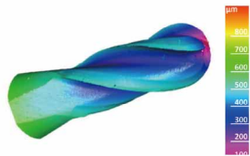
圖4. 微型銑刀的3D資料。顏色代表到軸心的距離。
